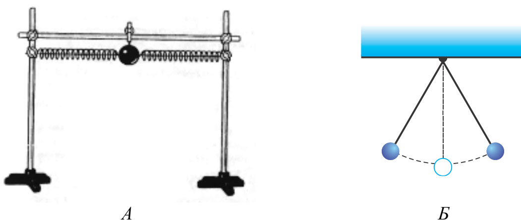
Рисунок 21 – Маятники: а) пружинный; б) математический.
