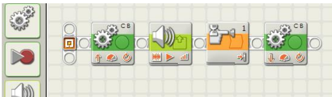
Рисунок 4 – Алгоритм программирования в среде NXT-G
